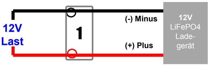
12V Anschluss mehrerer Batterien parallel
